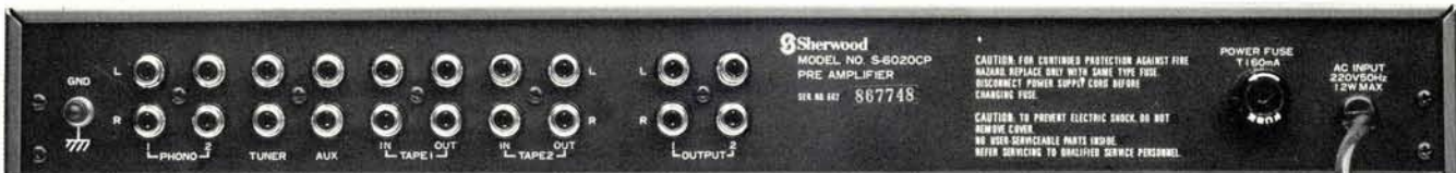
Il pannello posteriore del preampli. Le prese sono tutte PIN non dorate: notare la mancanza della duplicazione DIN
