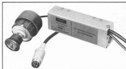
Verkehrs-Rundfunk-Decoder VD 1 Zum schnellen Auffinden von UKW-Verkehrs- rundfunk-Sendern mit Kennung (57 kHz). An- schließbar an UKW-Autosuper mit TB-Buchse. unverbindliche Preisempfehlung mit MWSt.: DM 70.-
