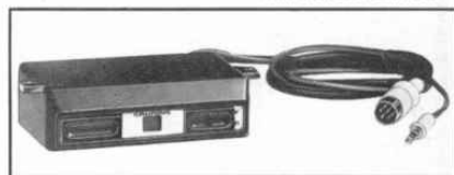
Verkehrs-Rundfunk-Decoder VD 3 Speziell für den Weltklang 4800. Für Montage unter dem Armaturenbrett (w. VD 2). Nach Umschalten des Schiebeschalters sucht der „Statomat“ nur Stationen, die Verkehrs- rundfunk-Programme ausstrahlen. Mit einer zusätzlichen Taste kann außerdem der Suchlauf direkt am VD 3 betätigt werden - Sie brauchen also nicht die Statomat-Taste des Autosupers zu drücken. Abmessungen: 114 x 35 x 70 mm (B x H x T) unverbindliche Preisempfehlung mit MWSt.: DM 70.-
