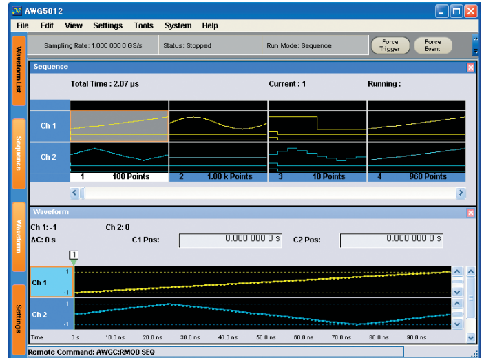
그림 33. 그래픽 편집기와 시퀀스 편집기를 결합하여 유연한 파형 생성에 활용하는 모습
